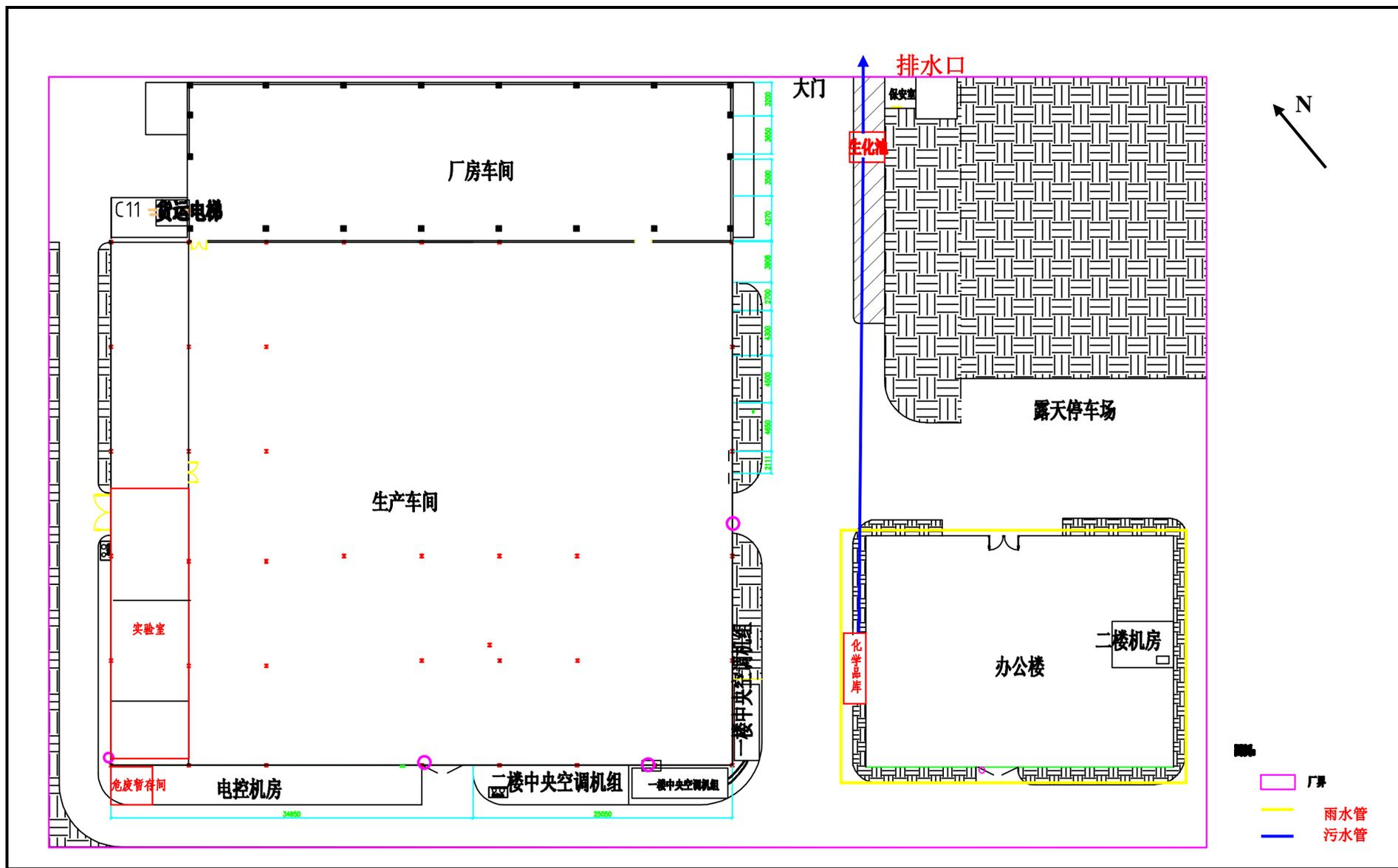
附图5 企业平面布置及排水管网图
